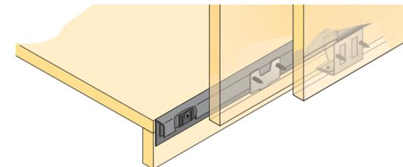
Das Aluminiumprofil wird bodenbündig angebracht und bildet einen sauberen Sockelabschluss.
