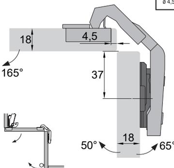
Используется в угловых шкафах со складными дверями в качестве средней петли. На корпус устанавливается петля Sensys 8657i с углом открытия 165° (смотрите схему H20).
