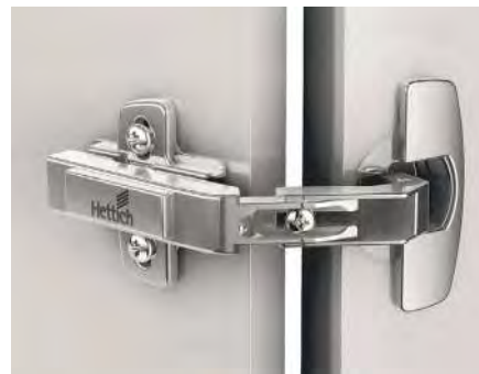
Intermat 9930 для складных дверей с чашкой в дизайне Sensys — скрытая петля с техникой защелкивания. Встроенная регулировка наложения и глубины. Регулировка по высоте на монтажной планке.
