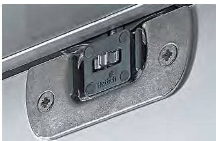
Удобная технология монтажа: двери просто защелкиваются на верхние ходовые элементы без использования какого-либо инструмента. Встроенная регулировка по высоте дает возможность точно выровнять фуги на фасаде.
