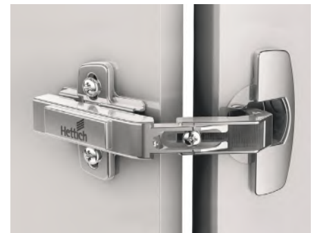
Intermat 9930 для складных дверей с чашкой в дизайне Sensys — скрытая петля с техникой защелкивания. Встроенная регулировка наложения и глубины. Регулировка по высоте на монтажной планке.
