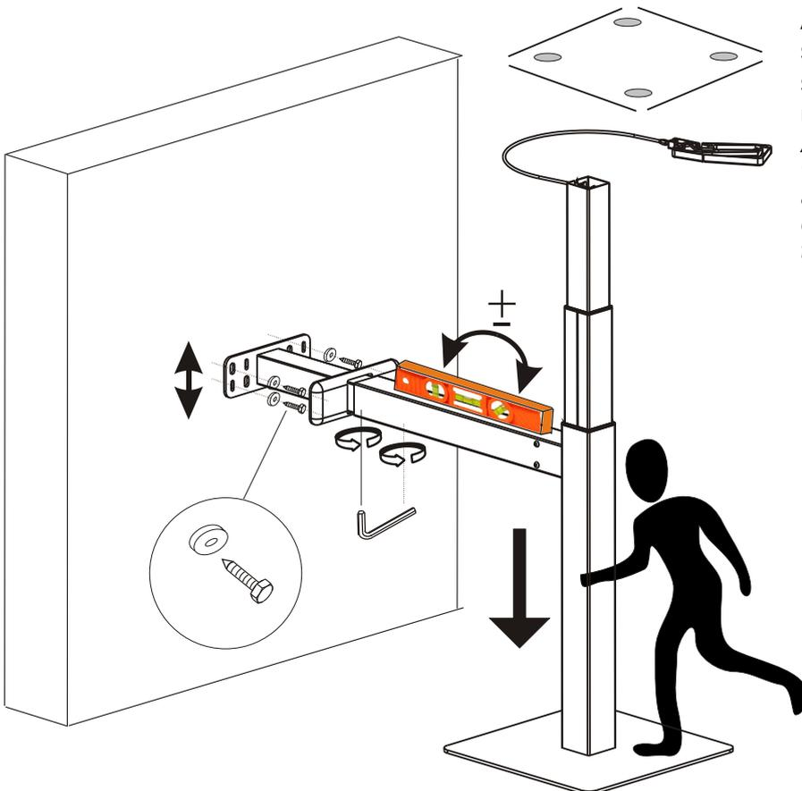
Ausrichten und Ecken mit Klebestreifen markieren. Säule beiseite stellen und Klebepads anbringen und Säule damit fixieren.
