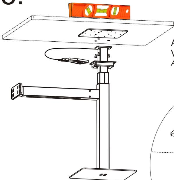
Ausrichten der Tischplatte unter Verwendung von Pass-Scheiben.
