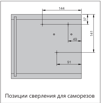
Позиции сверления для саморезов
