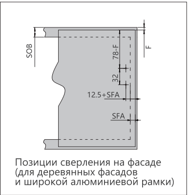
Позиции сверления на фасаде (для деревянных фасадов и широкой алюминиевой рамки) F – зазор
